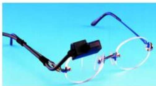
Figura 6: Óculos da Minolta com elemento holográfico (UEDA; 2000)
