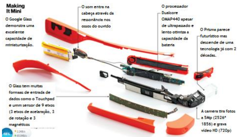
Figura 11: Componentes dos óculos da Google (retirado de https://www.google.com/glass/start/ )
