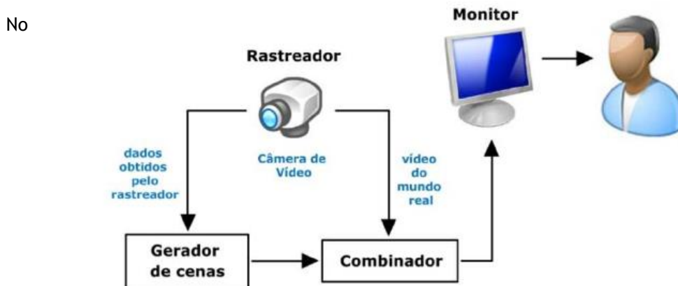
Figura 16: Sistema de RA baseado em monitor (adaptado de SILVEIRA; 2011)
