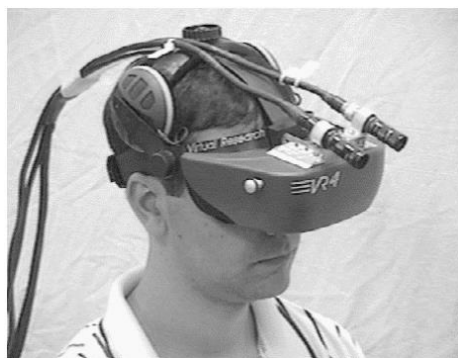
Figura 12: Sistema de visão direta por vídeo (adaptado de VALLINO; 1998)
